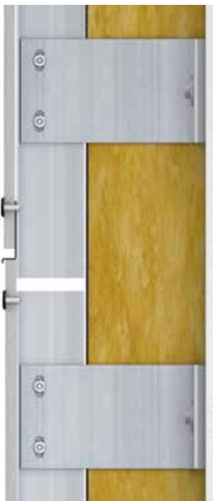
Giunto HardiePanel non allineato al giunto del profilo in alluminio
