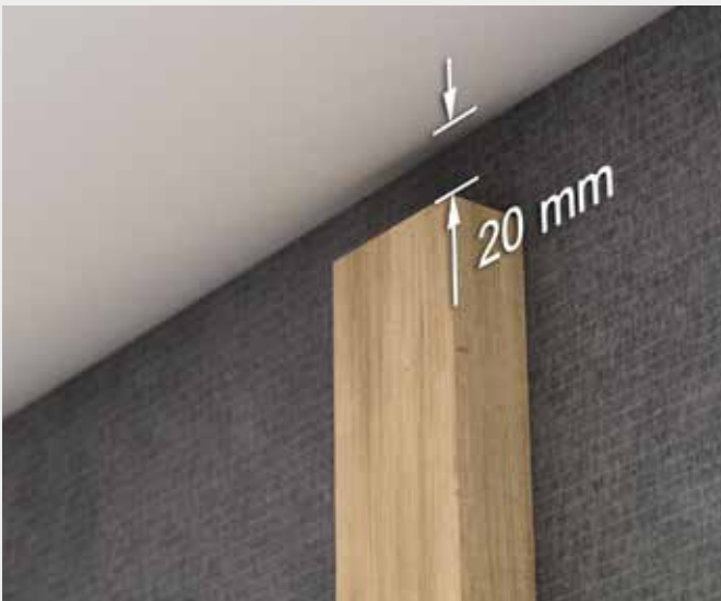
Distanza minima tra il bordo superiore del listello e il raccordo superiore.
