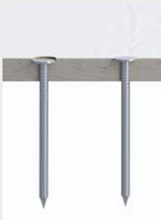
Elemento di fissaggio a filo o al massimo affondato di 1 mm.
