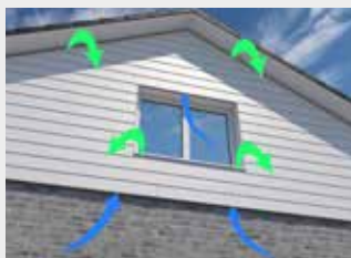
verde: espulsione d'aria blu: immissione d'aria
