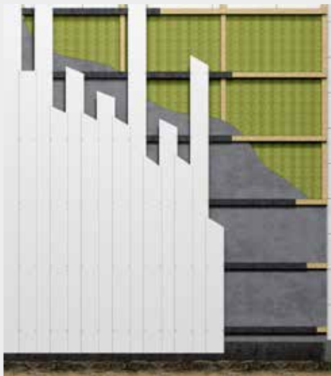
Disposizione del rivestimento in verticale con sovrapposizione di un secondo strato
