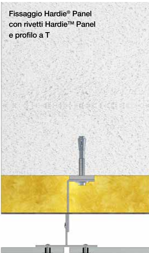
Fissaggio Hardie® Panel con rivetti Hardie™ Panel e profilo a L
